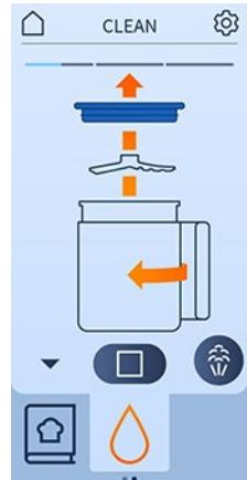
8. Desbloquee y retire el vaso protector girando hacia la derecha. Pulse para ello antes el botón de desbloqueo en el vaso protector.
