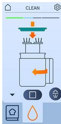
16. Una volta terminato il ciclo di pulizia, sblocca e rimuovi il recipiente di protezione ruotandolo verso destra. Per fare questo, premi prima il tasto di sblocco sul recipiente di protezione.
