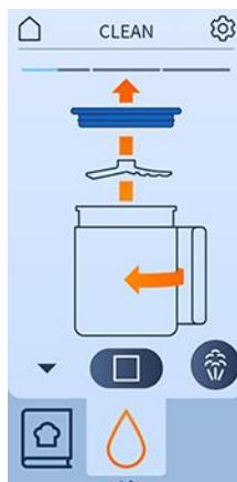
8. Sblocca e rimuovi il recipiente di protezione ruotandolo verso destra. Per fare questo, premi prima il tasto di sblocco sul recipiente di protezione.
