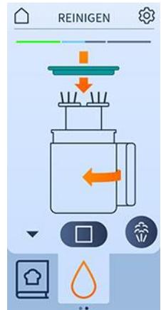
16. Nach Beendigung des Reinigungsvorganges entriegeln und entfernen Sie den Schutzbecher durch Drehung nach rechts. Drücken Sie hierzu vorgängig die Entriegelungstaste am Schutzbecher.
