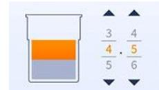
Die Menge der abgearbeiteten Portionen wird während der Verarbeitung durch orange Linien im Cup signalisiert.
