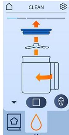
8. Déverrouiller et retirer le récipient protecteur en le tournant vers la droite. Pour ce faire, appuyez au préalable sur le bouton de déverrouillage du récipient protecteur.
